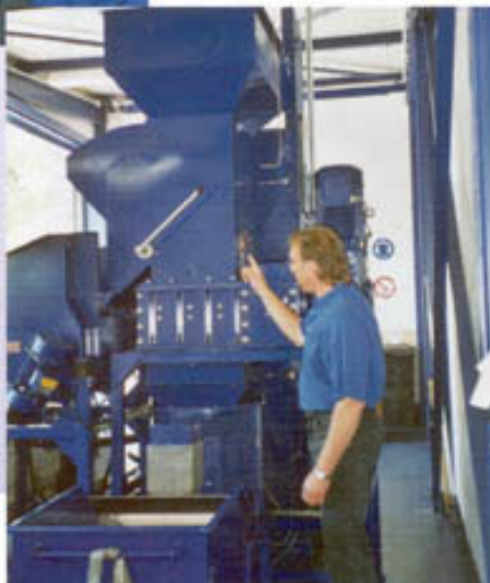
Eine professionelle Späne-Entsorgungs-Anlage zerkleinert im ersten Schritt den Abfall mit einem Schneidwerk. Danach wird mit Zentrifugalkraft das Öl herausgeschleudert. Zurück bleibt ein Granulat mit einem Restölgehalt von 3 %, das lediglich ein Sechstel des ursprünglichen Volumens besitzt
