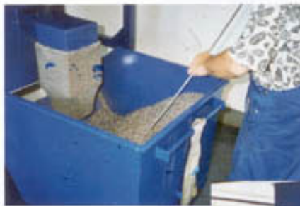
Eine professionelle Späne-Entsorgungs-Anlage zerkleinert im ersten Schritt den Abfall mit einem Schneidwerk. Danach wird mit Zentrifugalkraft das Öl herausgeschleudert. Zurück bleibt ein Granulat mit einem Restölgehalt von 3 %, das lediglich ein Sechstel des ursprünglichen Volumens besitzt
